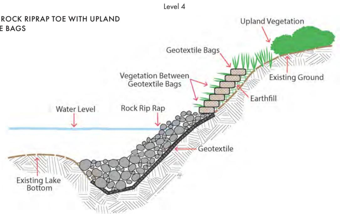
**ROCK RIPRAP TOE WITH UPLAND GEOTEXTILE BAGS**
